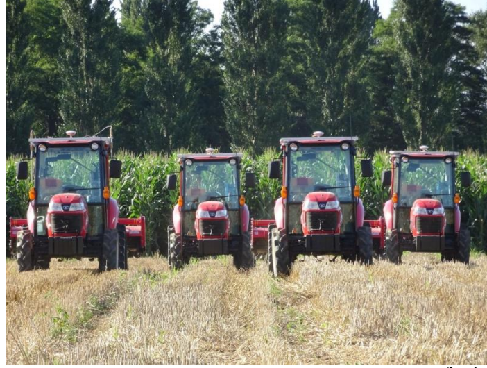
شكل (2) جرارات ذاتية التشغيل بالكامل تصطف إلى جانب بعضها البعض استعدادا لحث الحقل (حقوق الصورة لنوغوتشي نوبورو). https://www.nippon.com/ar
