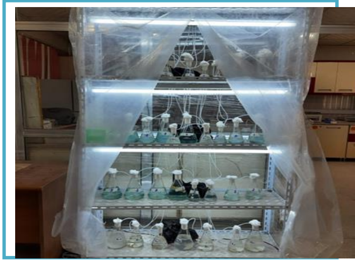
الشكل (3): صورة حاضنة زراعة السبيرولينا في المختبر.
