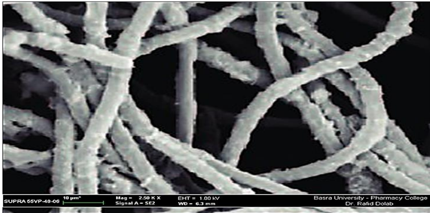
الشكل (2): صورة مورفولوجية لطحلب السبيرولينا بتقنية المجهر الإلكتروني الماسح (SEM) (5000X).
